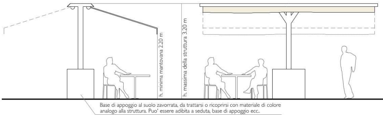
Fig. 3 Esempio di copertura con tenda autoportante, assimilabile ad ombrellone - tipologia retrattile a rullo con appoggio centrale. Prospetti frontale e laterale
